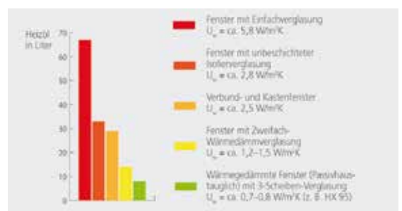
Vergleich des jährlichen Wärmeverlustes unterschiedlicher Fenstertypen pro m² Fensterfläche (umgerechnet in Liter Heizöl).
